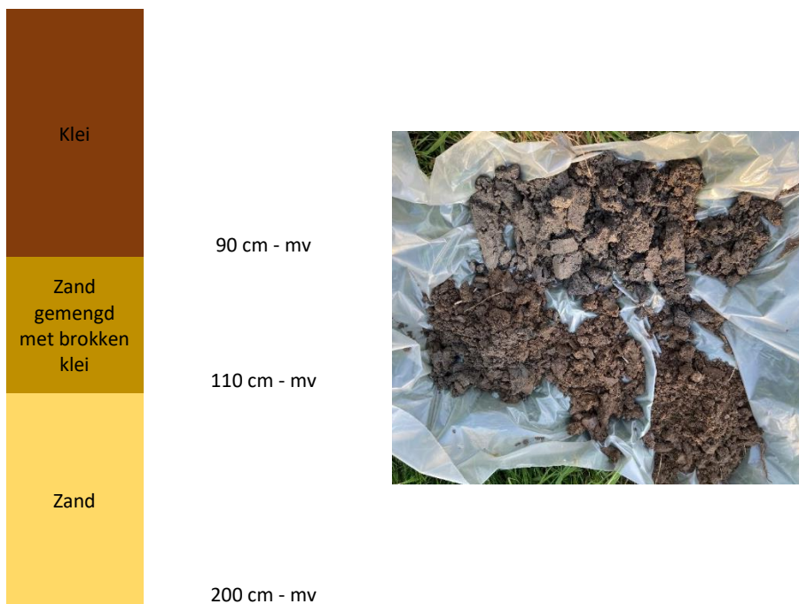
Figuur 19 Boorprofiel en foto van de grondlagen (klei bovenaan).
